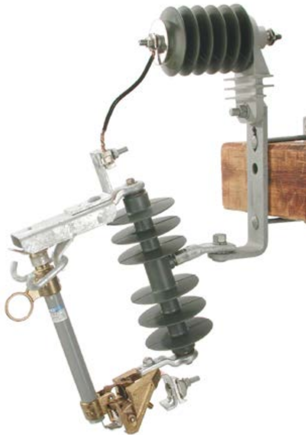
Cortacircuitos 15 kV con MOV de Ohio Brass directamente conectado, pararrayos de polímero de 9 kV
