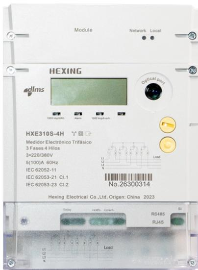
HXE310S-4H es un medidor electrónico trifásico multifunción, de conexión directa. Cumple con las normas internacionales y esta certificado por laboratorios acreditados. Posee amplias características y funcionalidades (según requerimiento del cliente) las cuales ofrecen máxima seguridad para los valiosos datos de medición. De diseño modular Plug & Play en caliente para poder adicionar diversos módulos de comunicación garantizando su adaptación en el mercado para distintas aplicaciones.
