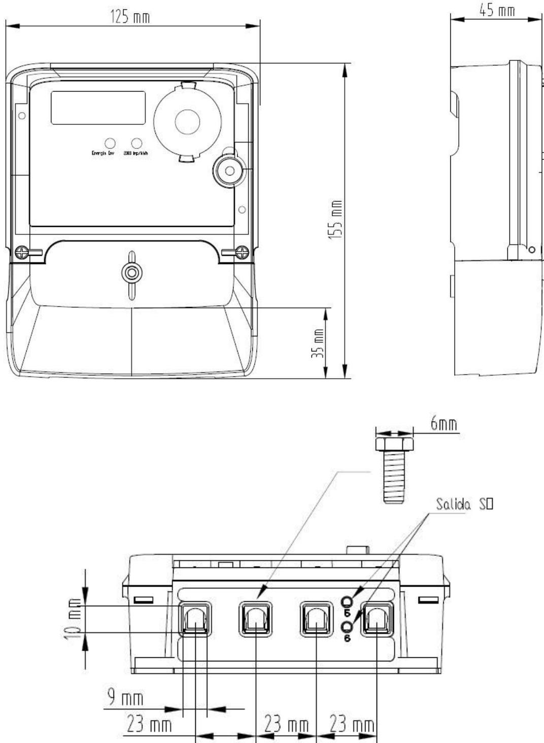
**Nota:** Cada una de las borneras cuenta con 2 tornillos de ajuste para el ingreso de los conductores
